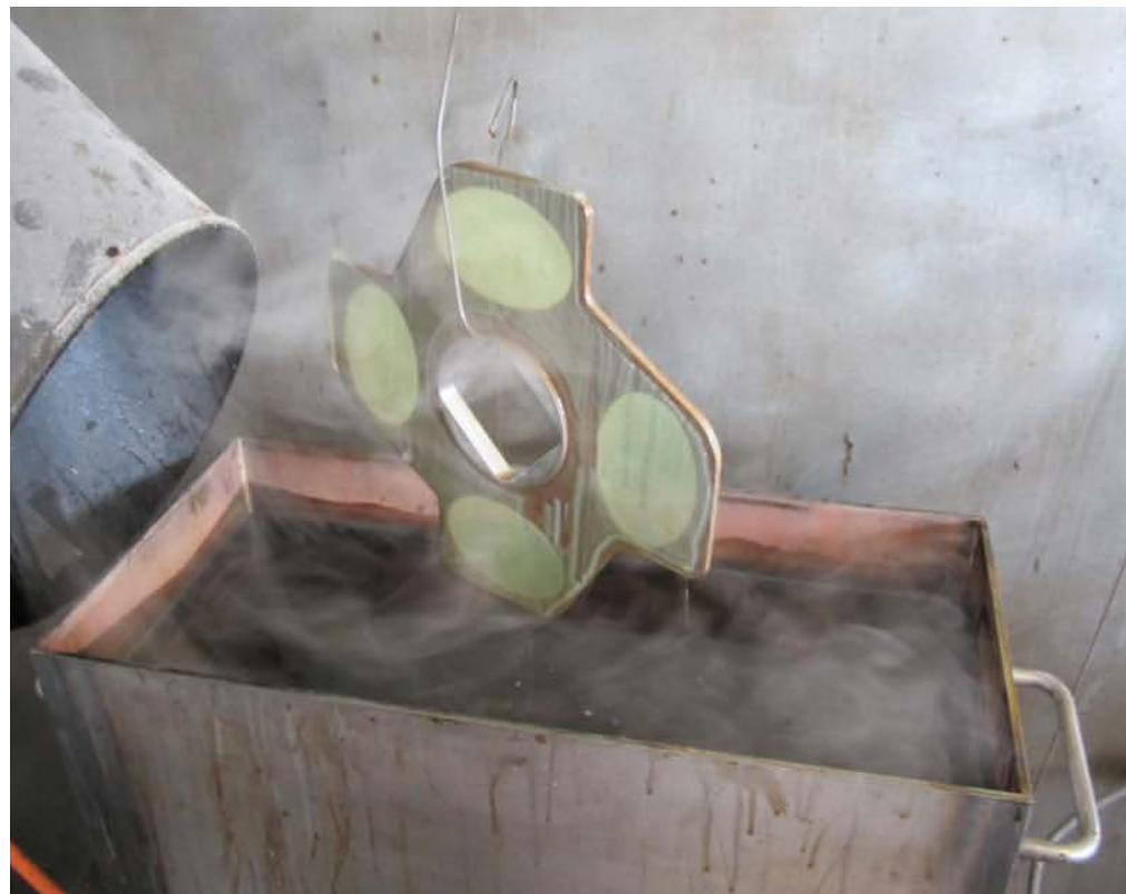
Bild 1. Das Einlegen von Teilen bei erhöhter Temperatur verbessert die Effizienz und Lösekraft der Kunststoffreiniger (Foto: Färber & Schmid)
